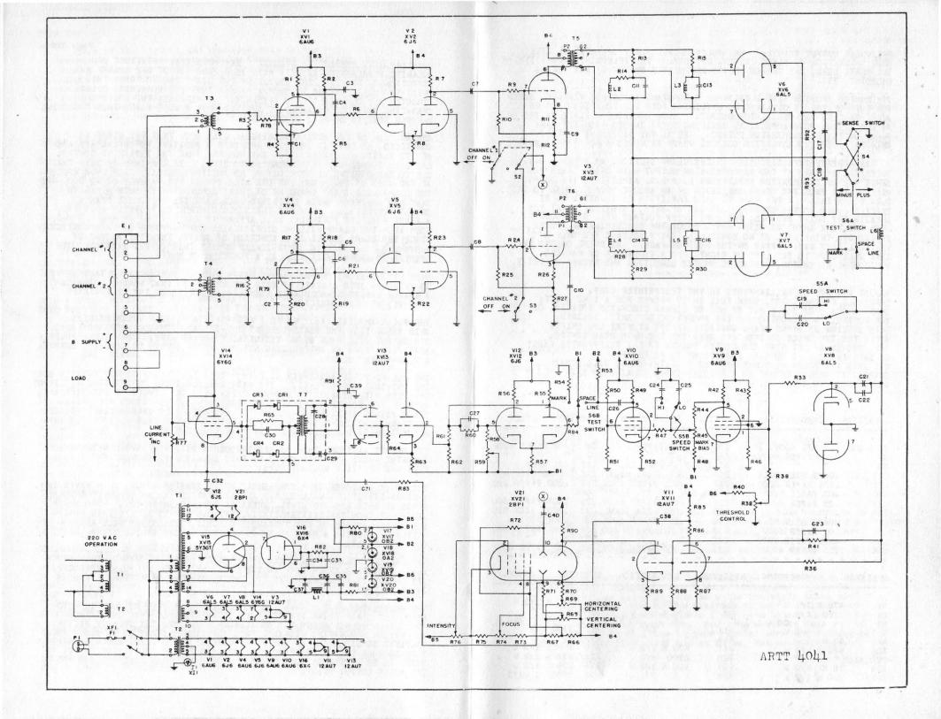
THE PULSE OUTPUT (V14):- THE PULSE OUTPUT STAGE OPERATES AT EITHER GRID SATURATION OR PLATE CURRENT CUT-OFF. THE TELEPRINTER CONSTITUTES THE PLATE LOAD, THE CURRENT BEING ADJUSTABLE BY USE OF THE SERIES RHEOSTAT, R77.
